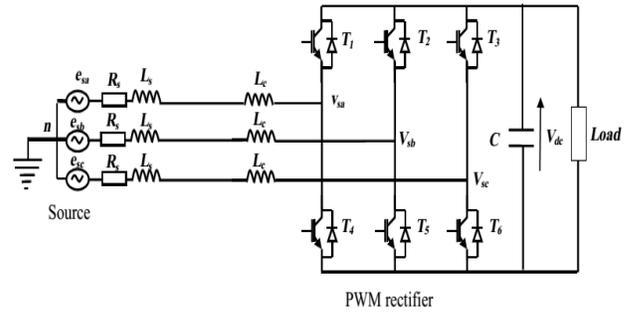
Fig. 1. Three-phase PWM rectifier converter
